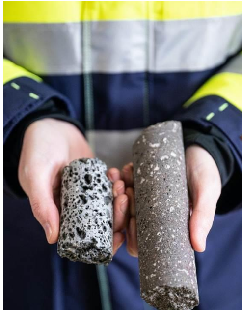
Mynd 1.3: Steindabinding CO 2 í basaltberggrunni. Til vinstri á mynd má sjá ferskt basalt sem ekki hefur hvarfast við CO 2 . Til hægri má sjá basalt sem hvarfast hefur við CO 2 . Líkt og sjá má hafa hvítar karbónatsteindir fyllt upp í holurými í berginu.
